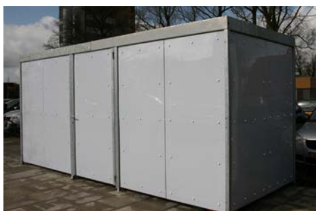
Wanden bekleed met opaal polycarbonaat
