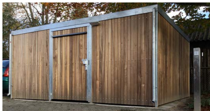
Brede deur met elektrische dagschootontgrendelaar
